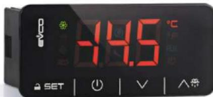
Температурный режим в холодильнике установлен производителем от  $-4^{\circ}\text{C}$  до  $+1^{\circ}\text{C}$ ., дифференциал равен 5. (т.е. при установке температуры на табло эл. контроллера  $-4^{\circ}\text{C}$ , температура в холодильной камере будет поддерживаться от  $-4^{\circ}\text{C}$  до  $+1^{\circ}\text{C}$ , при установке  $0^{\circ}\text{C}$  соответственно от  $0^{\circ}\text{C}$  до  $+5^{\circ}\text{C}$ ).
